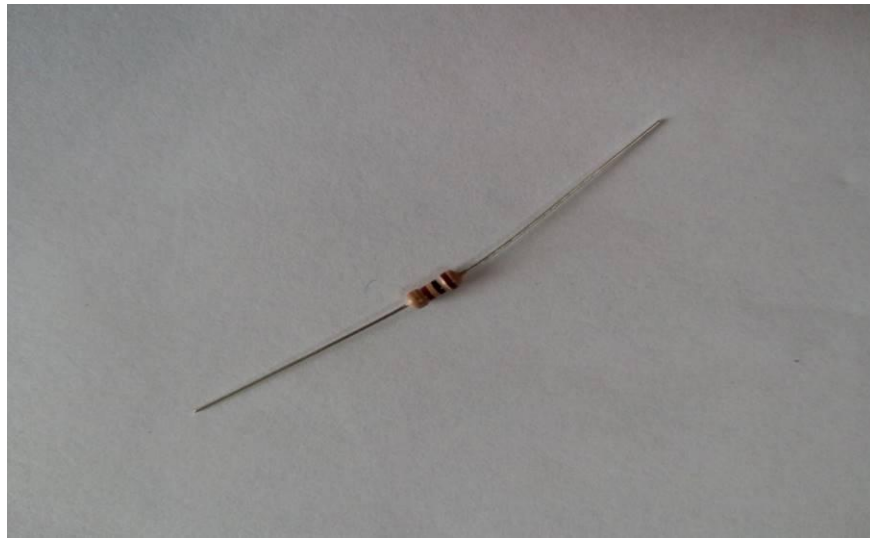
Figura 17: Resistor de 100Ω. Fonte: Bernartt (2014).
